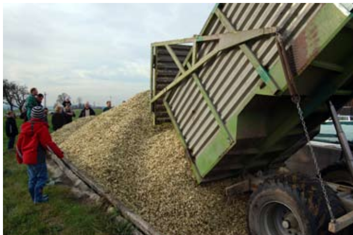
14 Traktoranhänger (Kipper) mit durchschnittlich 19 Kubikmeter Hackgut der Größe G30 konnten auf diesem 1 Hektar großen Feld geerntet werden.
